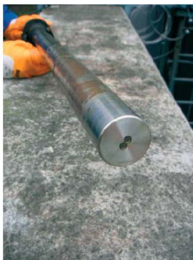
測定開始数週間後の ViSolid センサー
